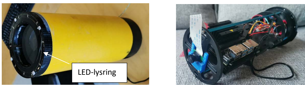
Figur 4: Sensorfisk med kamera. Innmat til høyre.
